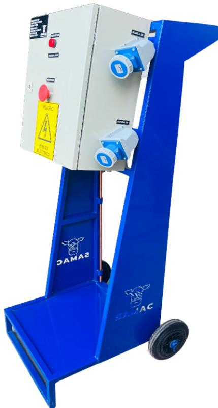
Atril móvil fabricado en perfil 25x25x1.5mm recubierto en placa de acero carbono de 2mm de expresor, la placa esta soldada a la estructura mediante soldadura MIG y el conjunto completo metalico electropintado azul el cual tiene ruedas de 200mm
